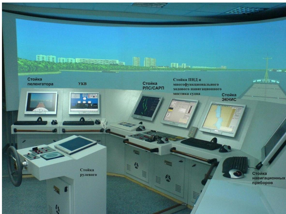
Общий вид многофункционального ходового навигационного мостика судна с проекционной системой визуализации
